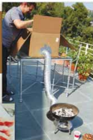
お手製のスモーク装置。好みのチップをたいて香りをつける。段ボール箱は、おいてしまうので1回ごとに取り替える。
